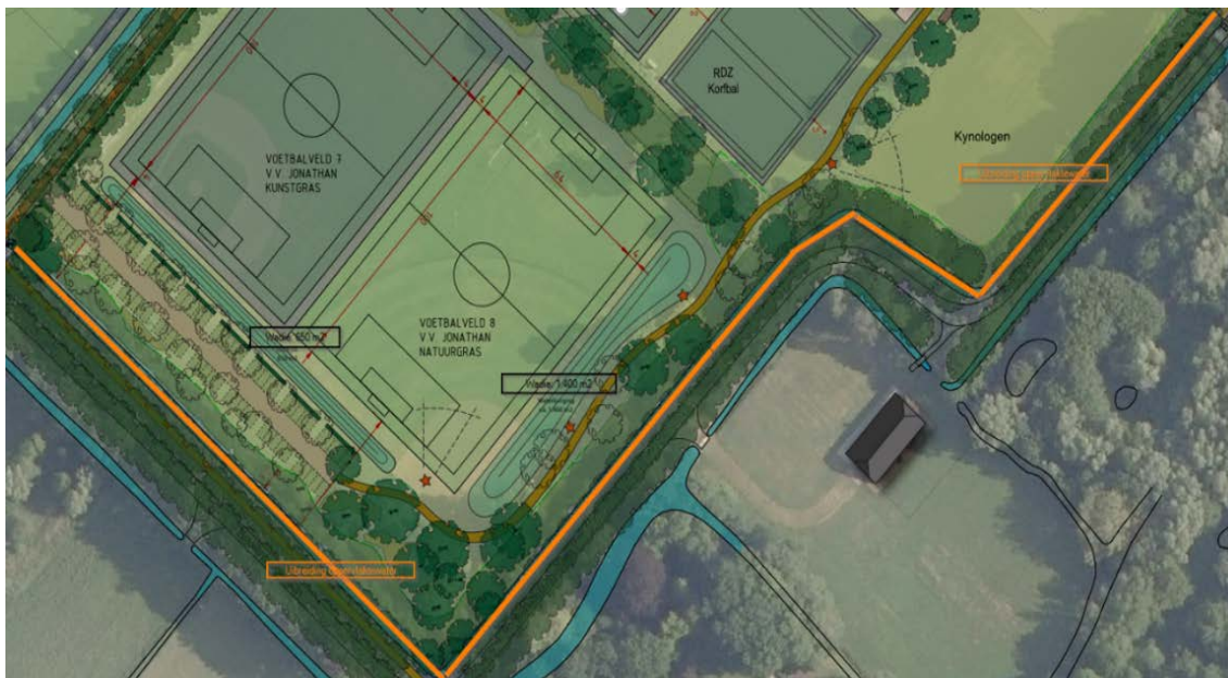
Figuur 4.14 compensatiemogelijkheden voor versnelde afvoer (wadi's en verbreden sloten)
